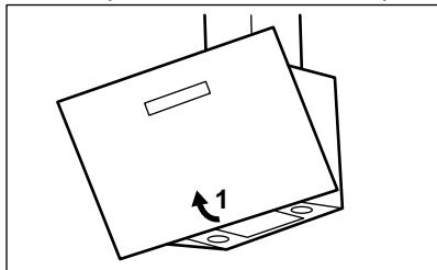
2. Натиснете дръжката на скобата за монтаж върху панела на филътъра под абсорбатора (1).
