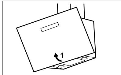
2. Stlačte rukoväť montážnej príchytky na paneli s filtrom na dolnej strane odsávača pár (1).
