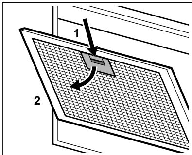
3. Немного наклоните переднюю часть фильтра вниз (2), а затем потяните. Повторите первые два действия с другими фильтрами.
