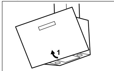
2. Druk op de handgreep van de montageclip op het filterpaneel onder de kap (1).
