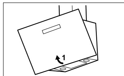
2. Stiskněte držadlo úchytky na panelu filtru pod odsavačem par (1).
