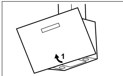
2. Нажмите на рукоятку фиксирующей защелки на панели фильтра под вытяжкой (1).
