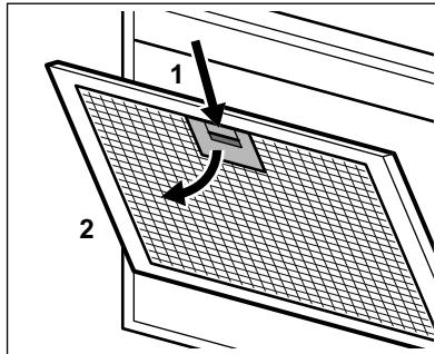
3. Kallutage filtri esiosa kergelt allapoole (2), seejärel tömmake. Korrale kahte esimest sammu kõigi filtritega.
