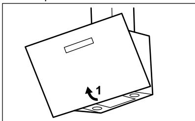
2. Притисните ручку затеге за монтажу на панелу филтера испод аспиратора (1).
