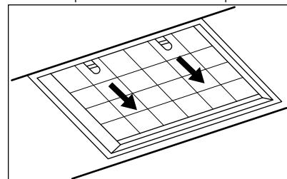
3. Incline ligeramente la parte delantera del filtro hacia abajo y tire.
