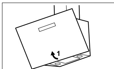
2. Pritisnite ručku montažne kopče na ploči filtra ispod nape (1).
