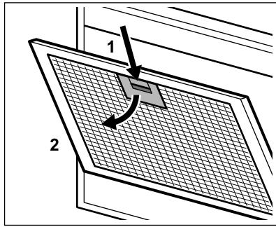
3. Злегка нахиліть передню частину фільтра вниз (2), потім потягніть. Повторіть перші два кроки для всіх фільтрів.
