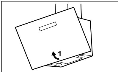
2. Drücken Sie den Griff der Befestigungsklammer an der Filtertafel unterhalb der Dunstabzugshaube (1).
