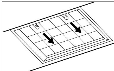
3. Kallutage filtri esiosa kergelt allapoole, seejärel tömmake.
