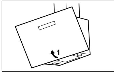
2. Натисніть ручку затискача кріплення на панелі фільтра під витяжкою (1).
